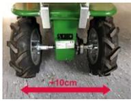
Kit élargissement pour moyeu de roues. Améliore la stabilité de la brouette électrique notamment sur des terrains très accidentés. Largeur extérieure au niveau des pneus 40 cm avec élargissement 50 cm.
