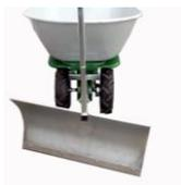
Lame à neige avec une largeur de travail de 75 cm munie d'une bande racleuse PUR, très robuste, permettant de ramasser la neige le mieux possible sur n'importe quel sol. Console d'attelage avec réglage de la hauteur, inclinable vers la droite et la gauche
