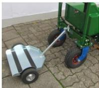
Remorque avec plate-forme à monter spécialement conçue pour les longs trajets entre le lieu de chargement de déchargement. Capacité de charge jusqu'à 100 kg.
