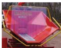
Trémie large avec tapis métallique
