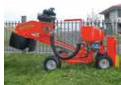
Bras de coupe télescopique jusqu'à 60 cm sur SGHD
