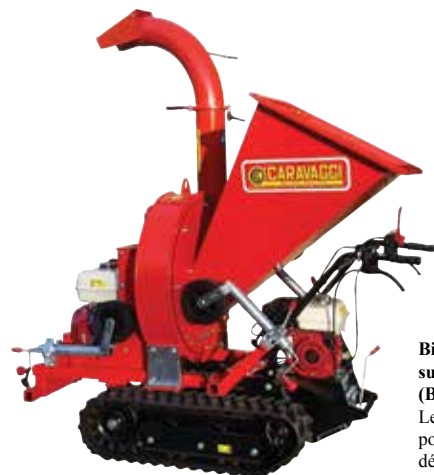
Bio 90 sur chenilles (BIO90H13TAC) Les béquilles peuvent rester en position travail ou être complètement déposées
