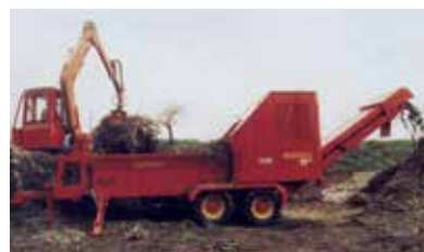
Bio 1250 de 429 cv avec grue de chargement et châssis agraire
