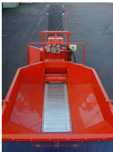
Trémie avec ouverture rabattable pour chargement frontal
