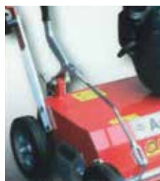
Levier de réglage de profondeur
