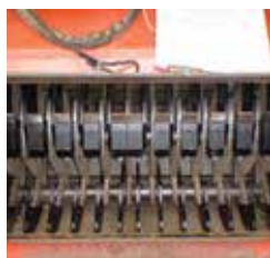
Rotor 3 en 1 équipé lames pour fabrication de plaquettes bois-énergie
