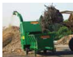
Bio 930 avec évacuation par goulotte orientable
