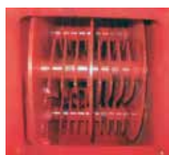
Rotor avec couteau de déshiquetage pour un rendement optimum
