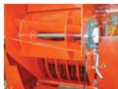
Turbine de ventilation et grille de calibrage sur BIO 300
