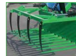
Fourche à fumier avec grappin hydraulique
