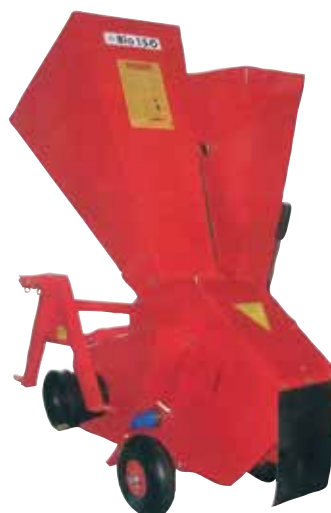
Modèle prise de force pour tracteur Réf. : CBIO150PDF Transmission à cardans fournie de série
