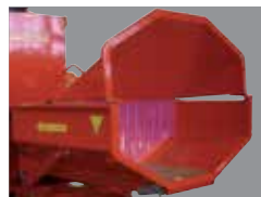
Trémie avec ouverture rabattable pour chargement frontal
