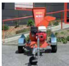
BIO 90 version châssis routier non freiné <499 kg
