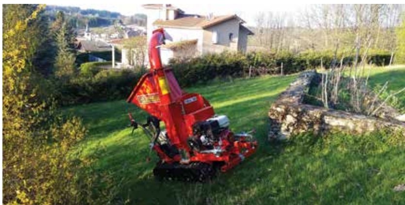
Bio 190 sur chenilles (BIO190H13TAC) Les béquilles peuvent rester en position travail ou être complètement déposées
