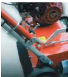
Repliage du brancard sur ARIO 50 moteurs GX200
