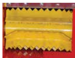
Rouleau ameneur à couteaux réducteurs de fourches
