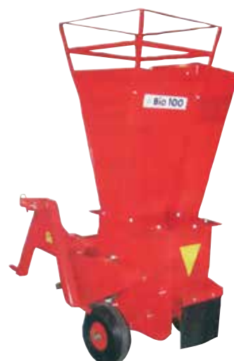
Modèle prise de force pour tracteur Réf. : CBIO100PDF Transmission à cardans fournie de série
