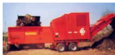
Bio 1900 avec moteur 514 cv et châssis agraire à 2 essieux
