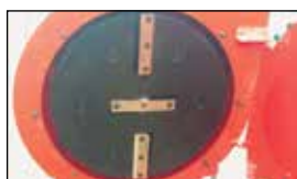
Rotor lourd à 3 lames en acier trempé et 24 marteaux mobiles
