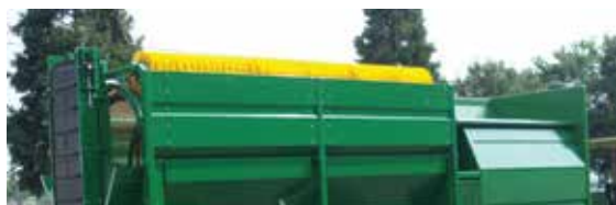
Balai rotatif (jaune) de nettoyage des grilles sur Vaglio 5000
