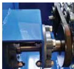
Paliers fonte avec graisseurs
