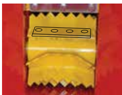
Rouleau ameneur à couteaux réducteurs de fourches
