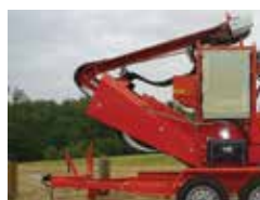
Repliage hydraulique du tapis d'évacuation
