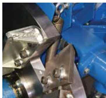
Rotor de 94 kg à 4 lames
